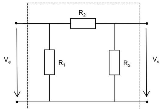
3. Considere a rede de dois portos representada na figura, com  $R_1=1K$ ,  $R_2=2K2$  e  $R_3=3K3$ .
