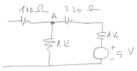
$$(V_A)_2 = \frac{1 \text{ k}}{1 \text{ k} + 220 \Omega + 1 \text{ k}} \times 5 \text{ V} \approx 2,2 \text{ V}$$
