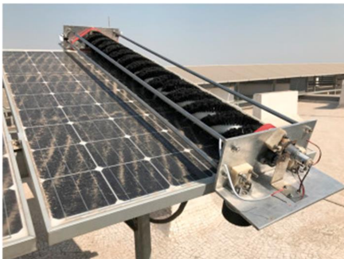
Figura 4: Método de limpeza de módulos fotovoltaicos completamente automático. Fonte: https://www.sciencedirect.com/science/article/pii/S1364032117313965
