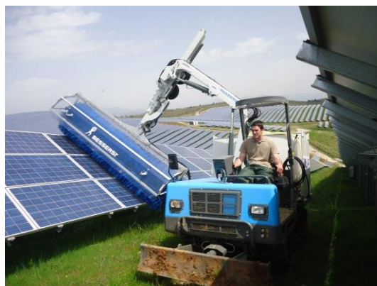
Figura 6: Representação do método de limpeza de módulos PV truck-mounted. Fonte: http://www.bitimec.com
