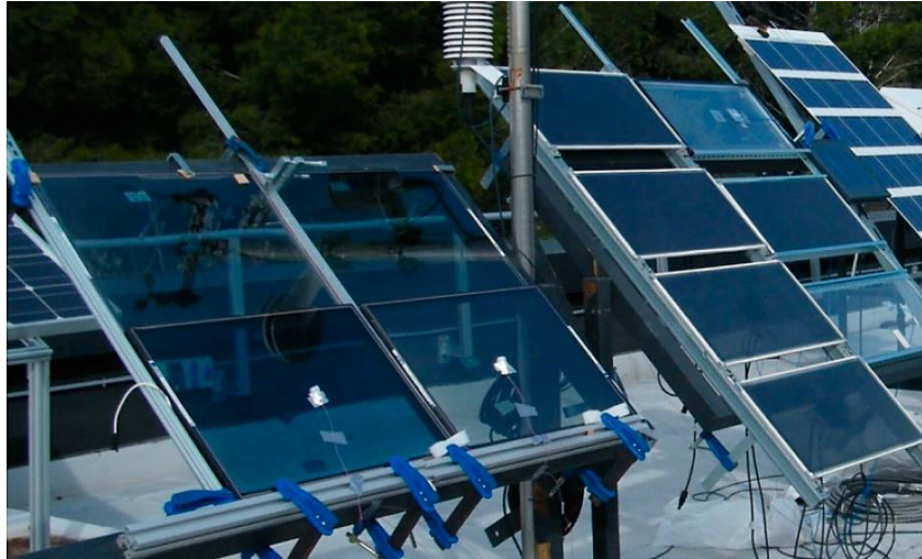
Fig. 5 – Montagem experimental ao ar livre de diversas amostras de STPV e ECSW. A temperatura superficial foi medida com recurso a termopares colocados na parte traseira do vidro das amostras, exceto nas amostras de vidros duplos [2].
