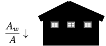
Figura 71: O aumento da área de vãos não se traduz num benefício térmico dada a fraca radiação solar da fachada.
