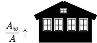
Figura 72: A utilização de vãos envidraçados é benéfica para a redução das necessidades de energia dada a elevada radiação solar na fachada.
