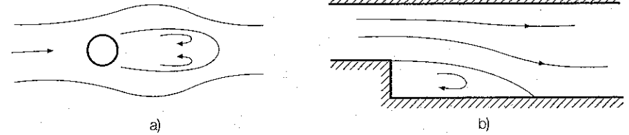
Figura 9.10 Métodos de estabilização de chama. a) Corpo não fuselado; b) Degrau.
