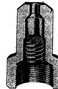
b) Atomizador com câmara de rotação de jacto cónico oco
