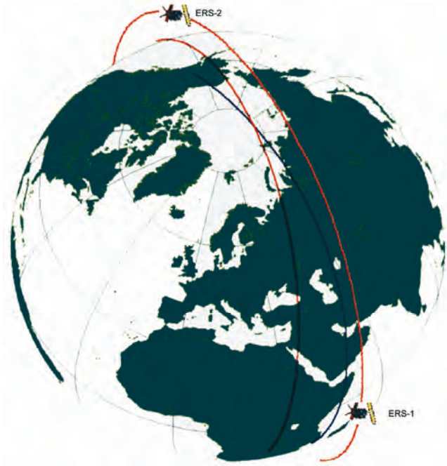
Figure 3-8: The ESA ERS-1 and ERS-2 Tandem mode
