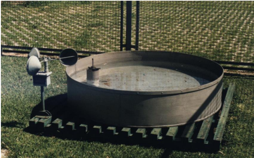
Figura 11.2 – Tina de Classe A, utilizada para medir a evaporação potencial, e anemómetro de copos tradicional. A variação do nível de água da tina é adicionada à precipitação ocorrida no mesmo período, obtendo-se a evaporação potencial. (Estação meteorológica do Instituto Geofísico do Infante D. Luís, fotografia J. Cristina).
