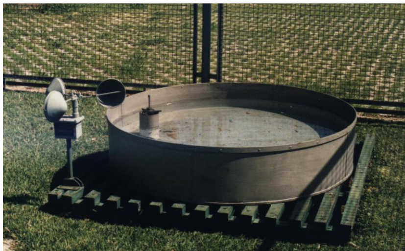
Figura 11.2 – Tina de Classe A, utilizada para medir a evaporação potencial, e anemómetro de copos tradicional. A variação do nível de água da tina é adicionada à precipitação ocorrida no mesmo período, obtendo-se a evaporação potencial. (Estação meteorológica do Instituto Geofísico do Infante D. Luís, fotografia J. Cristina).
