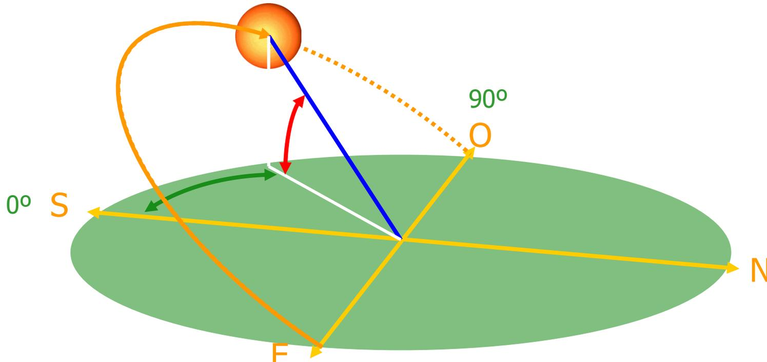
Podemos calcular a potência que receberíamos numa superfície horizontal em qualquer sítio em qualquer instante do ano
