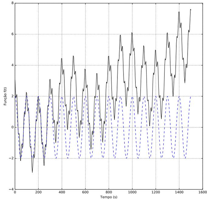
O sinal que queremos reter é a curva sinusoidal com período de 100 s e amplitude igual a 2, ou seja, é a função  $f_1(t)$ . Um possível filtro espectral é o filtro passa-banda desenhado a vermelho na figura abaixo:
