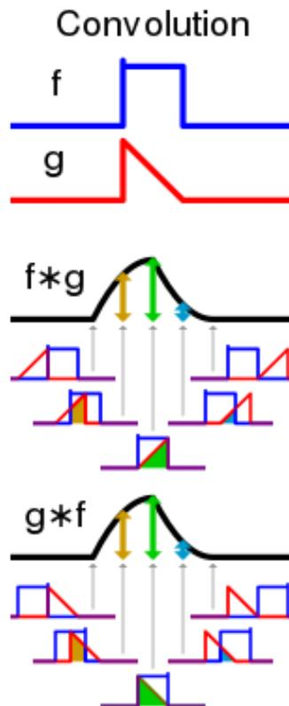
As convoluções podem ser utilizadas para filtrar sinais, como no caso do filtro de média móvel, em que se aplica a convolução com uma função rectangular para filtrar os períodos inferiores ao comprimento do rectângulo.
