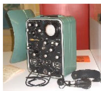
Telurómetro MRA-2 (1956), distanciómetro de ondas radio-eléctricas
