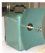
Telurómetro MRA-2 (1956), distanciómetro de ondas radio-eléctricas
