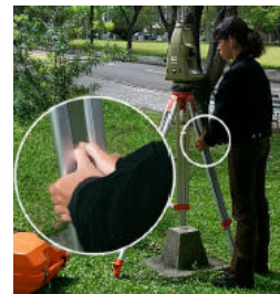
3. Eixo principal do aparelho passando pelo ponto estação utilizando o prumo óptico ou laser
