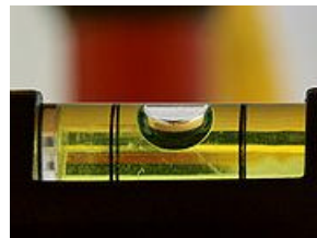
nível tórico para definir uma direcção horizontal
