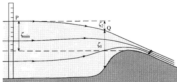
Figure 3: Dispositivo para medir a taxa de escoamento.
