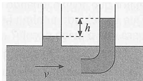
Figure 2: Dispositivo para medir a velocidade.
