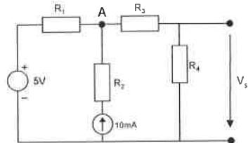
3. Considere a rede de dois portos representada na figura, com  $R_1=470\Omega$ ,  $R_2=220\Omega$ ,  $R_3=1k\Omega$ . Determine a respectiva matriz híbrida. [3 valores]
