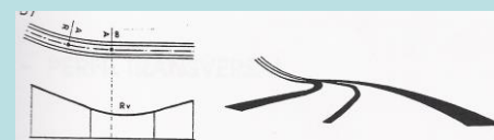
Concordância côncava após uma curva circular provocando quebra do traçado e estreitamento óptico da estrada
