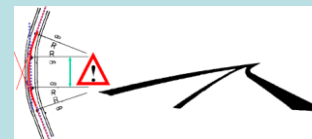
Mau traçado em planta (pequeno alinhamento entre duas curvas com o mesmo sentido): os alinhamentos rectos entre duas curvas circulares consecutivas com o mesmo sentido devem ter um comprimento que corresponda a um tempo de percurso mínimo de 5 segundos. Se isso não for possível, é preferível substituir as duas curvas e o alinhamento recto por uma curva única
