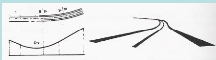
Início de curva circular após uma concordância côncava, provocando uma quebra do traçado
