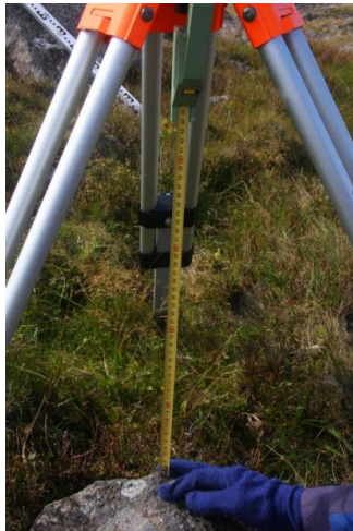
Antena sobre tripé: leitura vertical
