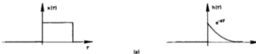
A figura seguinte apresenta a solução para este problema, comparando a correlação com a convolução destas duas funções. A grande diferença está na ausência da operação de “espelhamento” de uma das funções na correlação.
