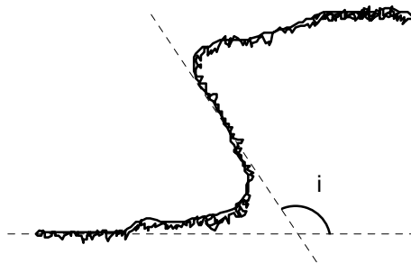
Fig. 34. Terreno de declive negativo.
