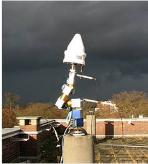
Figura 16 - Calibração de antenas GPS em modo absoluto.
