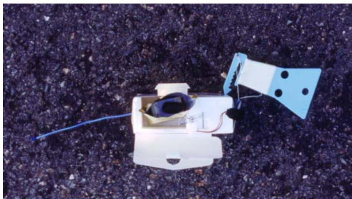
Figura 22 - Aquisição de dados de um balão meteorológico.
