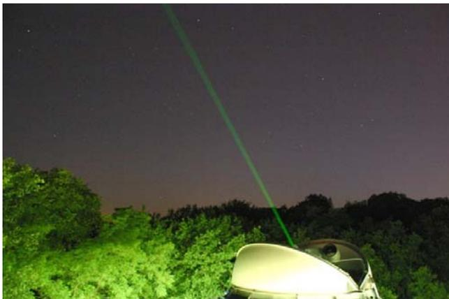
A medição de distâncias para satélites (incluindo a Lua) usando laser, designadas abreviadamente SLR (*Satellite Laser Ranging*) e LLR (*Lunar Laser Ranging*), consoante o alvo é um satélite artificial ou a Lua, consiste basicamente na medição do tempo gasto por um pequeno pulso de
