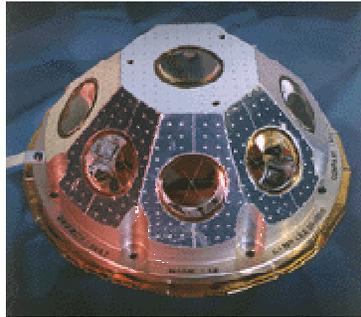
Figura 4 – retroreflector usado no satélite ENVISAT.
