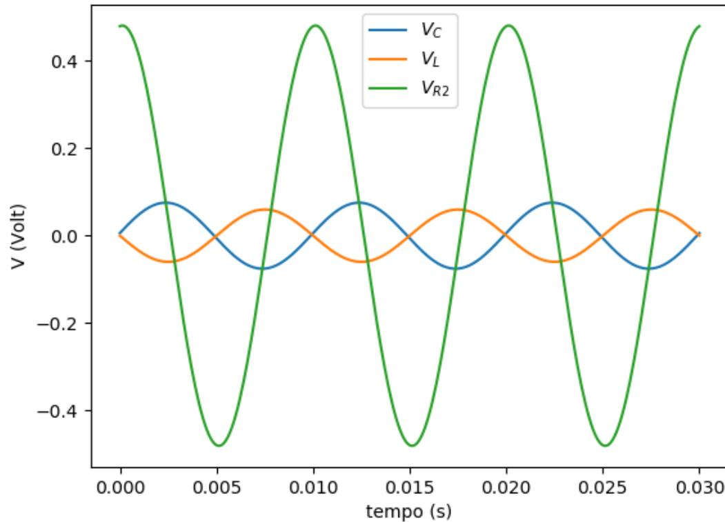
Isto seria o que veríamos no osciloscópio aos terminais de cada componente
