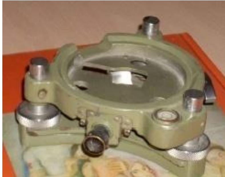
**1. A base é constituída por um cilindro apoiado em 3 braços, em cujas extremidades se encontram 3 parafusos nivelantes destinados a horizontalizar a base (e por construção a verticalizar o eixo principal).**
