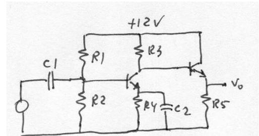
4. Considere o seguinte amplificador.  $R_1=200\text{ k}\Omega$ ;  $R_2=28\text{ k}\Omega$ ;  $R_3=22\text{ k}\Omega$ ;  $R_4=22\text{ k}\Omega$ ;  $C=10\ \mu\text{F}$
