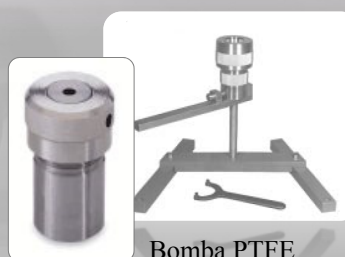
Bomba PTFE clássica: Recipiente de Teflon (20-125 ml) contido num copo de níquel ou aço inox.
