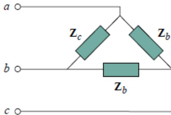
Tal como acontece com a forma de ligação de um gerador trifásico, as cargas trifásicas também podem ser ligadas em duas configurações: estrela e triângulo
