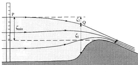
Figure 4: Dispositivo para medir a taxa de escoamento.
