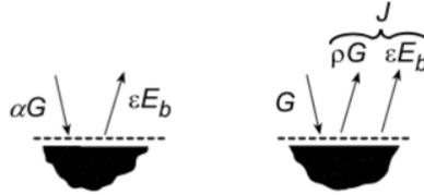
O fluxo de radiação será a diferença entre o que é absorvido  $G_{\text{abs}}$  e emitido  $E_S$  pela superfície. É também a diferença entre a radiação incidente e a radiosidade.
