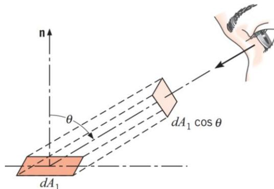
Se a superfície recetora estivesse a  $90^\circ$ , então a superfície emissora seria somente uma linha do ponto de vista da superfície recetora. Podemos calcular o fluxo de radiação interceptado na superfície 4 para diferentes direções e vemos que:
