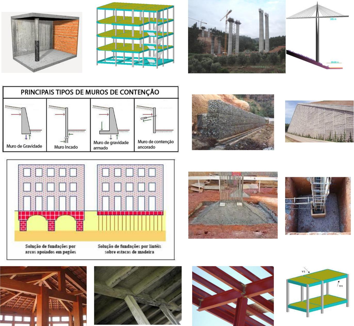
figura 4.4. Exemplos de pilares, muros de suporte, fundações e vigas
