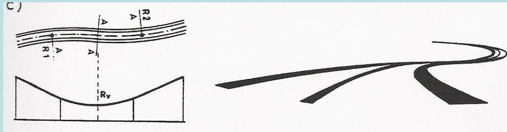
**Concordância côncava entre duas curvas circulares provocando quebra e estreitamento óptico da estrada**
