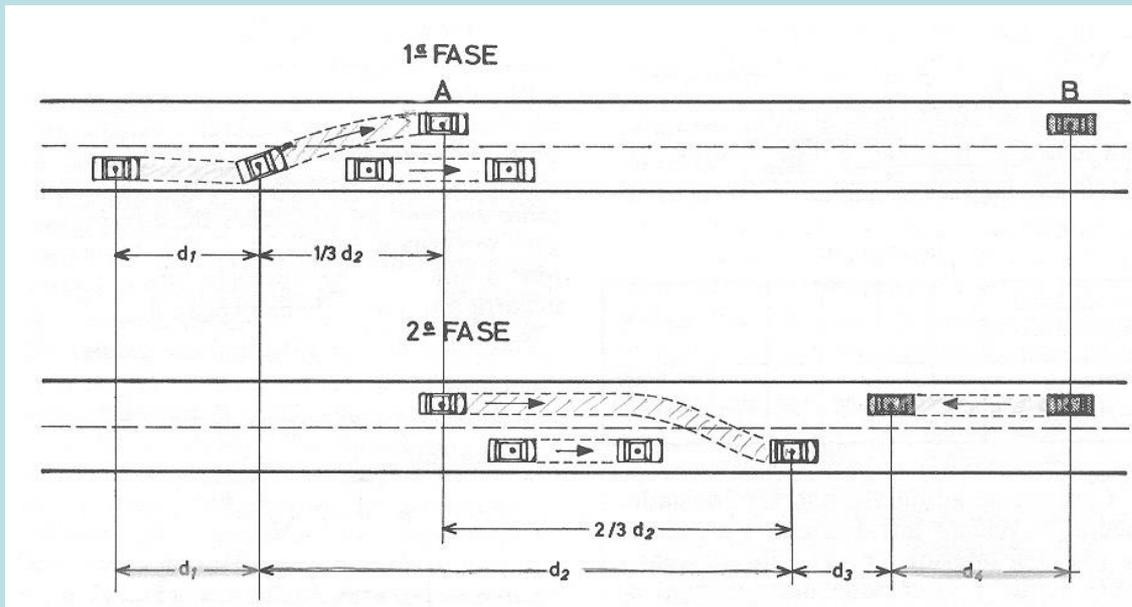
$d_1$ : distância percorrida pelo veículo ultrapassante durante o tempo  $t_1$  de percepção e reação do condutor e de aceleração do veículo
