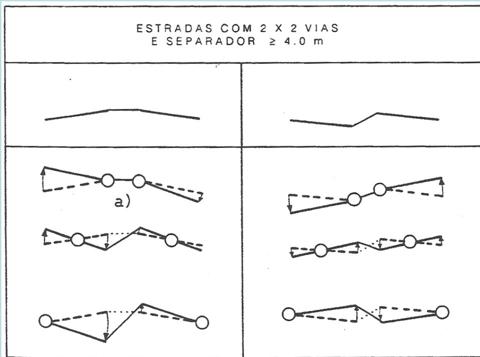
Na transição da tangente para a curva, a escolha do eixo de rotação depende do tipo de inclinação transversal no alinhamento recto, do valor da sobreelevação e das condições locais. Actualmente, nas estradas com duas faixas de rodagem, preconiza-se a rotação em torno do eixo da faixa de rodagem; nas estradas com faixas de rodagem unidireccionais, a rotação deve ser efectuada em torno do bordo interior de cada uma das faixas de rodagem.
