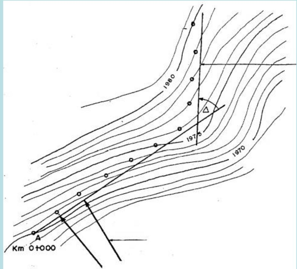
Estudo detalhado da implantação do traçado sobre cartografia com equidistância natural igual a 1m
