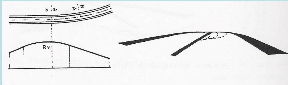
**Início da curva circular após concordância convexa, o que impede ver a mudança de direcção em planta**
