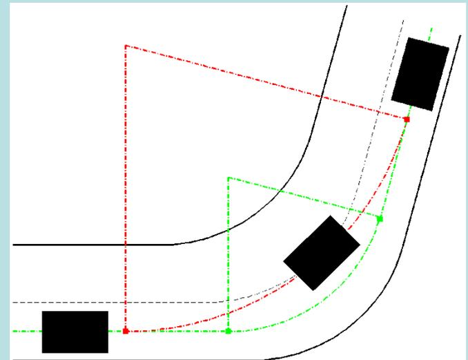
Tendo em consideração a topografia, o **raio de uma curva circular** deverá ser o **maior possível**, o que facilita a visibilidade e a percepção do traçado pelos condutores;
