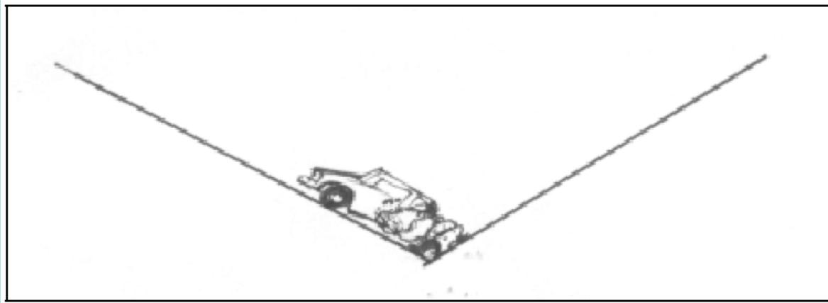
De forma semelhante ao caso horizontal, onde se introduziram curvas de transição para evitar descontinuidades na variação da curvatura ao longo da directriz, **no caso vertical unem-se as tangentes adjacentes de diferentes declive através de arcos de parábola**, devido à sua simplicidade e à variação constante de gradiente ao longo da curva. Há a considerar duas formas para estas curvas: convexas e côncavas.
