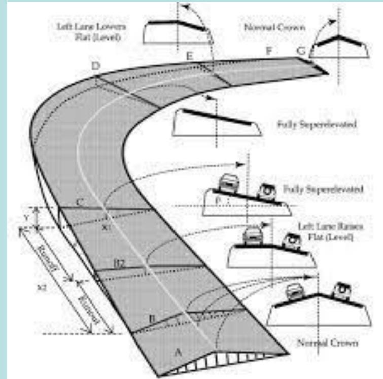
No **caso mais complexo** de disfarces de sobrelevação que envolvam a rotação simultânea de mais do que uma faixa de rodagem em torno de um eixo de rotação coincidente com um dos bordos da estrada, a variação das elevações do outro bordo da estrada em relação ao eixo de rotação é efectuada a um ritmo mais acentuado.
