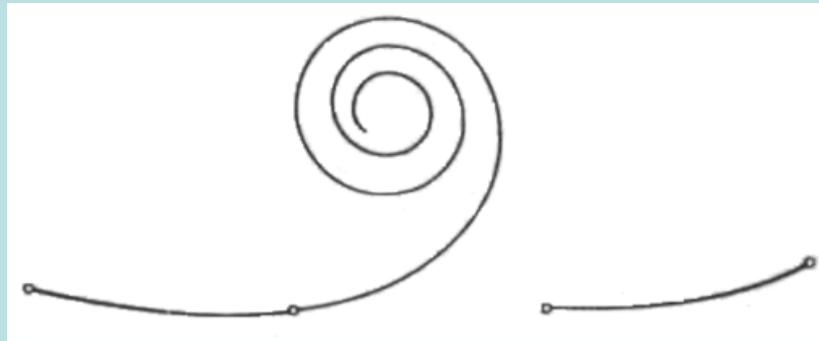
**Sendo  $P$  um ponto genérico sobre a clotóide,  $L$  a distância sobre a clotóide desde a origem até o ponto  $P$ ,  $\Delta$  o ângulo entre a tangente à clotóide em  $P$  e o eixo  $X$  e  $R$  o raio de curvatura da clotóide em  $P$ , considere-se um deslocamento infinitesimal  $dL$  sobre a curva, a que corresponde o ângulo infinitesimal  $d\Delta$ .**
