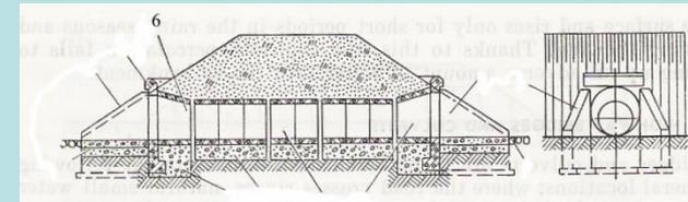
1=vala de intersecção; 2=vala de drenagem; 3=talude; 4=pavimento inclinado; 5=aqueduto subterrâneo;6=linha de água
