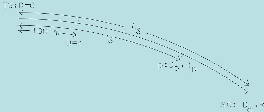
Assim, sendo  $L_s$  o comprimento (extensão) do arco de clotóide (entre os pontos TS e SC), tem-se
