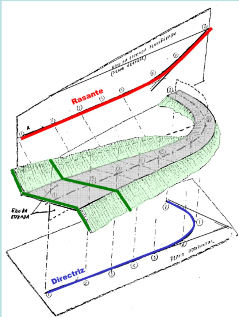
Eixo da estrada: **superfície** regrada cuja directriz vertical coincide sucessivamente com o eixo dos perfis transversais.
