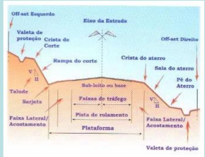
Nos alinhamentos rectos a inclinação transversal da estrada deve-se exclusivamente à drenagem de águas pluviais. De acordo com a norma, essa inclinação deverá ser de **2.5%** nos pavimentos betuminosos e **2%** nos pavimentos em betão de cimento.
