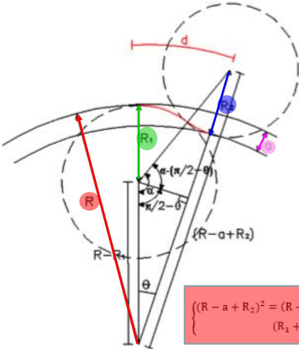
Curva reversa efectuando a ligação entre 2 curvas circulares concêntricas de raios \$R\$ e \$R-a\$, sendo \$R\_1\$ e \$R\_2\$ os raios das 2 curvas reversas de transição
