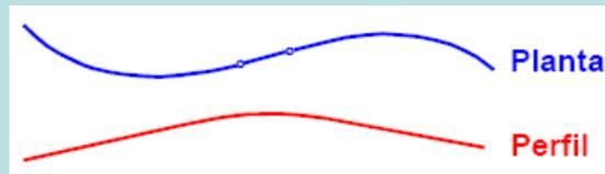
Tangente curta entre curvas horizontais, no topo de uma curva vertical convexa: dificulta a percepção da segunda curva
