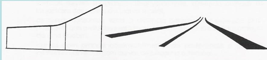
**Mau traçado em perfil (concordância diminuta):** o raio de uma curva vertical entre trainéis extensos deve ser muito superior aos mínimos indicados nas normas.
