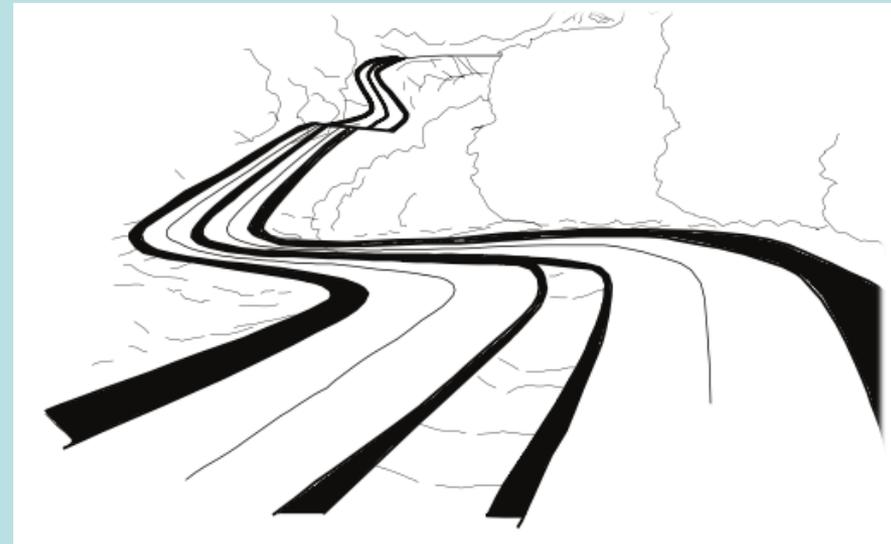
Um traçado **pode** respeitar integralmente as normas em planta e perfil e a estrada uma vez construída apresentar-se desagradável e **não** assegurar a segurança e comodidade de circulação. Na escolha da localização do traçado deve-se sempre tentar visualizar a estrada uma vez concluída e avaliar as consequências das possíveis **combinações de traçado em planta e perfil**, respeitando os seguintes princípios:
