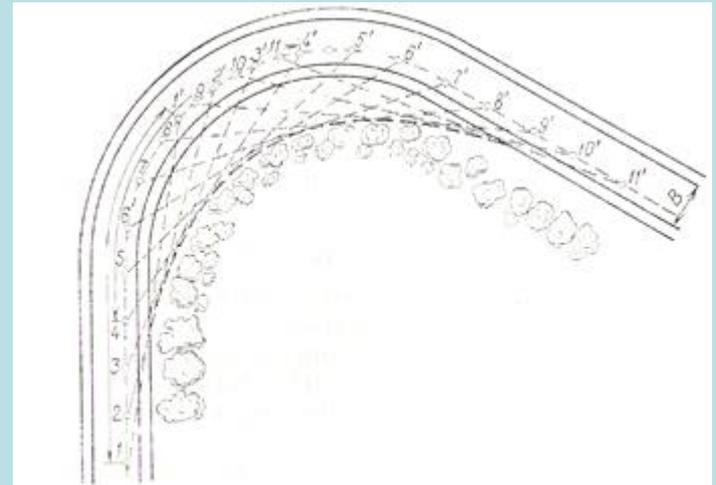
Nos locais onde existam obstruções no lado interior das curvas horizontais (tais como muros de suporte, taludes, pilares de uma estrutura, construções ou árvores), é necessário garantir uma distância de visibilidade adequada, **sendo o raio da curva determinado em função da distância de visibilidade de paragem.**
