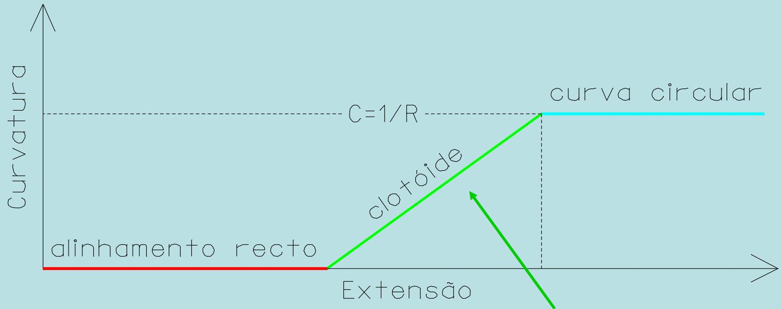
ao longo da clotóide a curvatura varia de forma contínua desde 0 até  $1/R$  ou, em termos da aceleração centrífuga, desde 0 até ao valor  $V^2/R$
