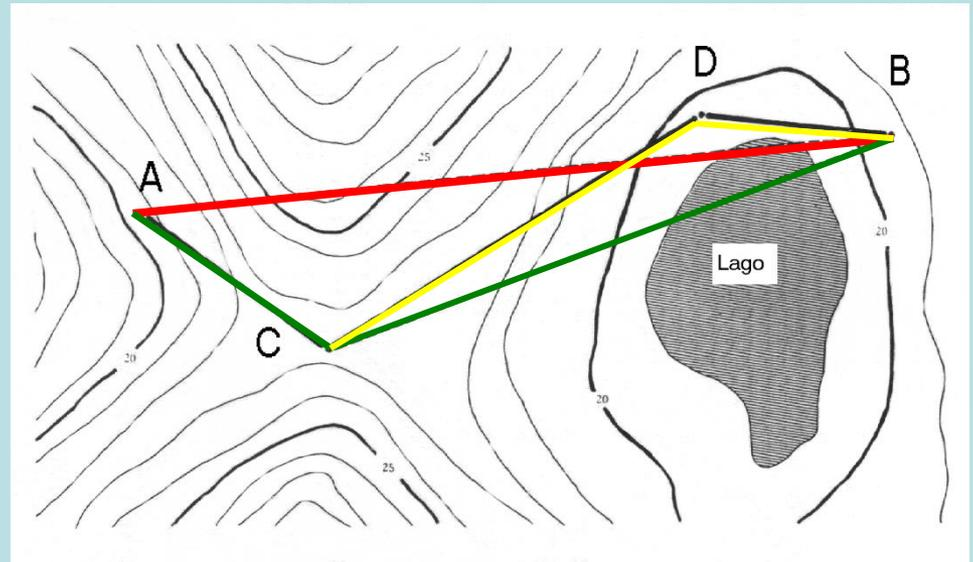
segmentos de recta AC e CB; se entre C e B existir outro obstáculo, como um lago, define-se outro ponto forçado de passagem D. Desta forma, a sucessão de pontos forçados de passagem define uma **poligonal** que indicará a direcção geral do traçado.
