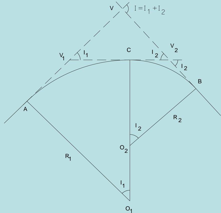
$A=P.C.1$ ,  $B=P.T.2$ ,  $C=P.T.1=P.C.2=P.C.C.$ ,  $T_1=V_1C$ ,  $T_2=V_2C$ ,  $TL=AV$ ,  $TR=BV$
