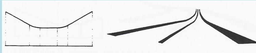
**Mau traçado em perfil (pequeno tranel entre duas concordâncias côncavas) : entre duas curvas verticais próximas deve-se evitar colocar um tranel de reduzida extensão.**
