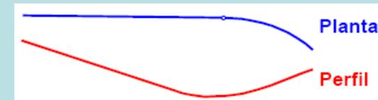
Curva horizontal começando no ponto mais baixo da curva vertical côncava com rampas longas: cria aparência de curva circular com raio mínimo
