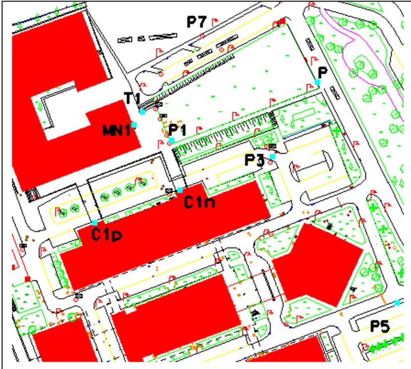
1. **Objectivo:** Atribuir altitude ortométrica através da realização de nivelamento geométrico aos pontos **P, P1, P3 e P7** efectuando os dois percursos **T1-P1-P-P7-T1** e **C1n-P1-P-P3-P5**.
