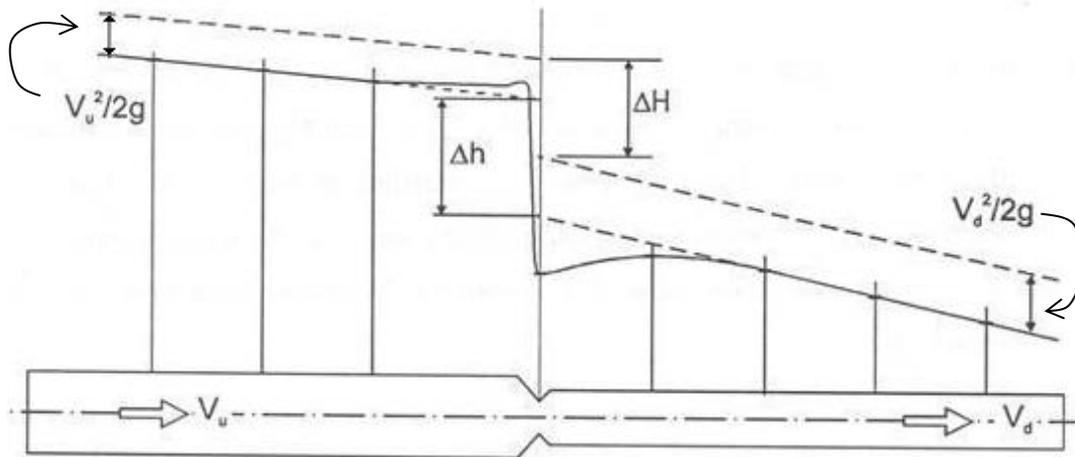
Na figura desta página, estão representados exemplos das alterações de geometria que ocorrem no circuito hidráulico utilizado nesta experiência, as quais implicam a perda de carga total do escoamento.
