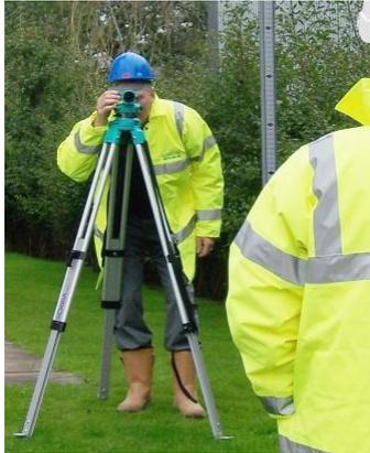
Um trabalho de nivelamento que pode ser realizado recorrendo à utilização de um único estacionamento do nível (no caso de os pontos A e B serem suficientemente próximos) designa-se por **nivelamento geométrico simples**.
