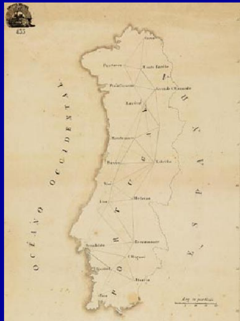
Fig.1. Primeiro esquema de triangulação projectado por Ciera após as expedições geográficas de 1790-91. Reprodução do original pertencente à Direcção dos Serviços de Engenharia.
