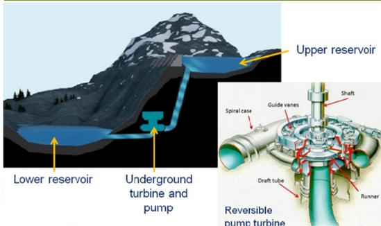
**Centrais reversíveis (turbino - bombas/pumped storage systems) tirando partido de energia remanescente e/ou de condições do mercado.**
