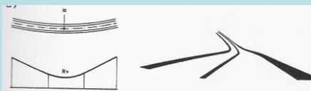
Curva circular de grande raio e concordância côncava de pequeno raio, provocando quebra do traçado em planta
