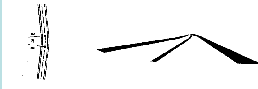
Mau traçado em planta (raio diminuto)
