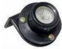
nível esférico para definir um plano horizontal
