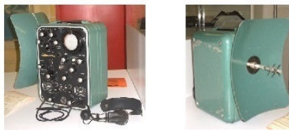
Telurómetro MRA-2 (1956), distanciómetro de ondas radio-eléctricas
