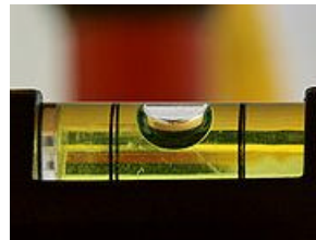
nível tórico para definir uma direcção horizontal
