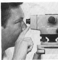
Fig. 5 Control del funcionamiento con el botón pulsador antes de la lectura
