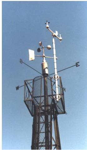
Figura 6.1 – Anemómetro de copos e cata-vento: sistema tradicional lado a lado com anemómetro de estação automática. (Estação do Instituto Geofísico do Infante D. Luís, fotografia J. Cristina)
