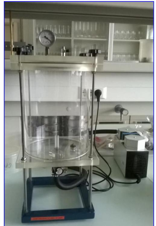
Figura 1 – Câmara de vácuo
