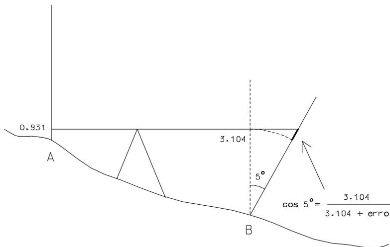
A leitura à frente em B seria:  $3.104 + \text{erro} = 3.104 / \cos 5^\circ = 3.116$ , pelo que o desnível entre A e B seria -2.185 m.
