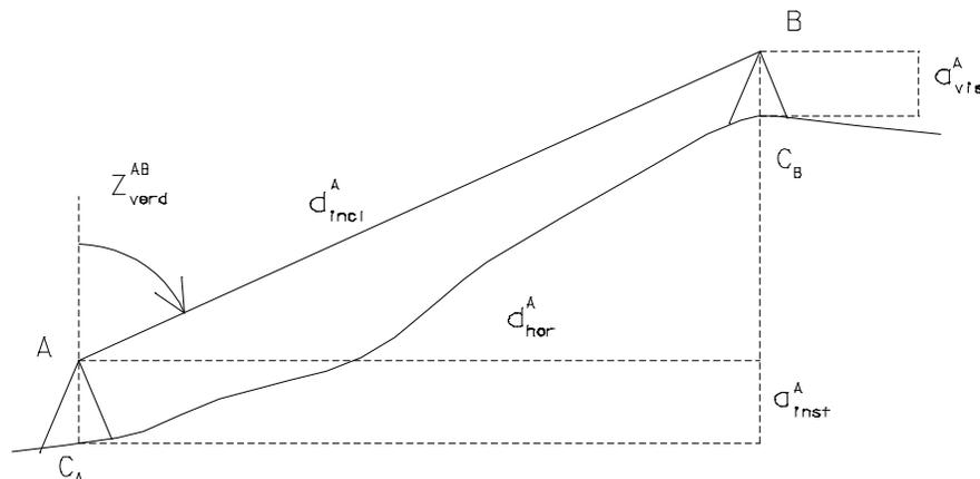
Da figura, sendo  $Z_{\text{verd}}^{AB}$  a distância zenital verdadeira (geométrica) correspondente à visada de A para B:
