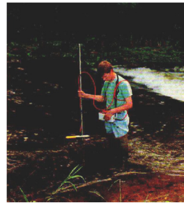
Medição a vau com molinete eletromagnético (ott)
