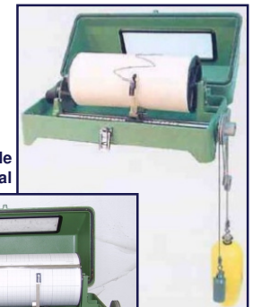
Limnógrafo de flutuador de tambor vertical e registo diário ou semanal para colocação em poço
