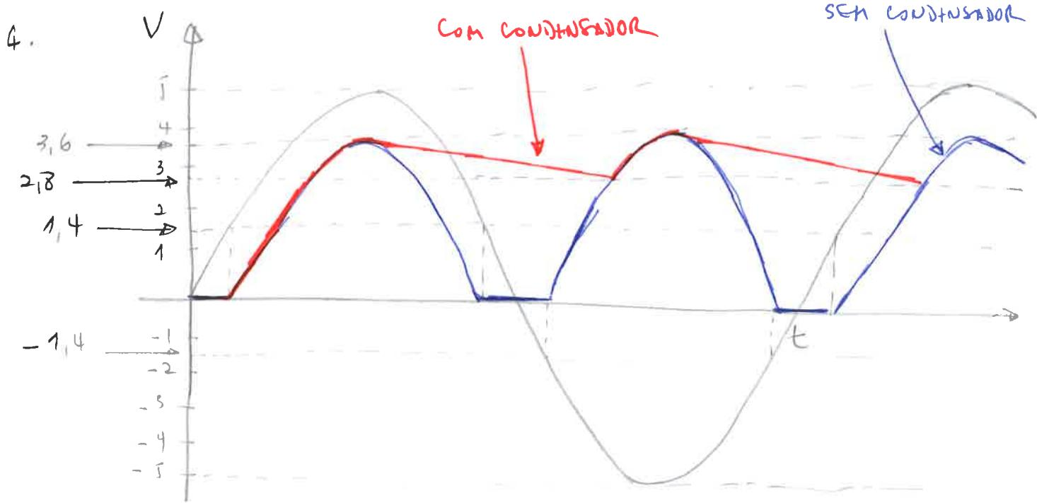
$$\Delta V_C = \frac{(V_0 - 1,4)}{2f R_C C} = \frac{(5 - 1,4)}{2 \times 10^3 \times 1 \times 10^3 \times 2,2 \times 10^{-6}} \quad V \approx 0,8 \text{ V}$$
