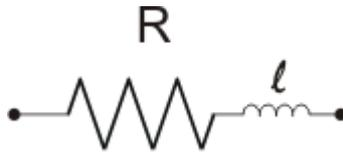
Figura 1.28 - Esquema equivalente de resistência real
