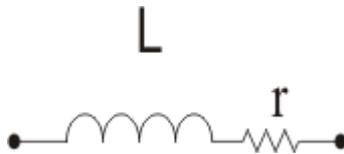
Figura 1.29 - Esquema equivalente de uma bobine real
