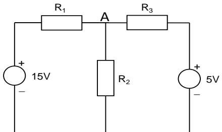
2. Considere a rede de dois portos representada na figura, com  $R_1=4K7$ ,  $R_2=2K2$  e  $R_3=3K3$ .
