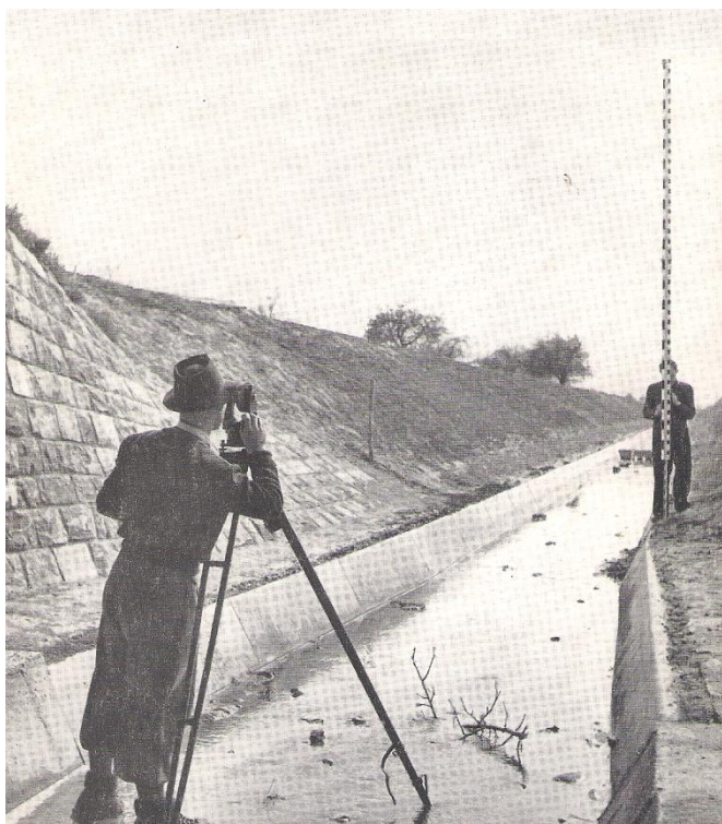
medição estadimétrica de distâncias
